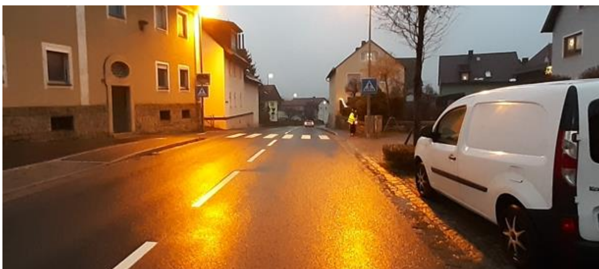
Bild 23: durch Kuppe und Parkstände eingeschränkte Sichtbeziehung Kraftfahrer – Fußgänger
